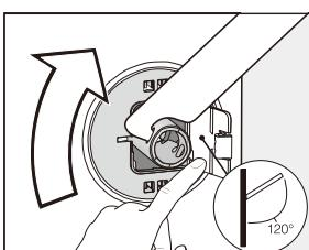
カバーを開き、付属のオーブンスパナを使用して、輸送用ボルトを90°回します。
