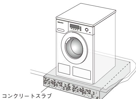
洗濯機を設置する床は、床下が直接コンクリートスラブに密着しているか確認してください。
