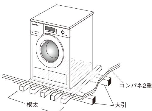
直接コンクリートで補強するのが困難な場合、左図のように根太5~6本+コンパネ2重張で補強してください。
