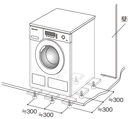
マンションなどの置床の場合、機器を設置する床下を、根太受け金具（フリースタンパー）9本で補強します。金具の取り付け位置は、概ね下図を参考にしてください。
