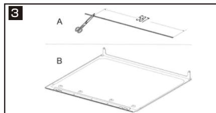
本体後部の天板固定金具左右2箇所を取り外します。
