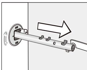
スパナのカギ部分を使って輸送用ボルトを引き出します。
